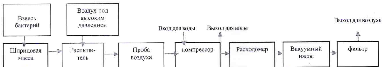
Рисунок А.1 — Принцип работы прибора для испытания эффективности бактериальной фильтрации
