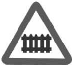
1.1 Железнодорожный переезд со шлагбаумом
